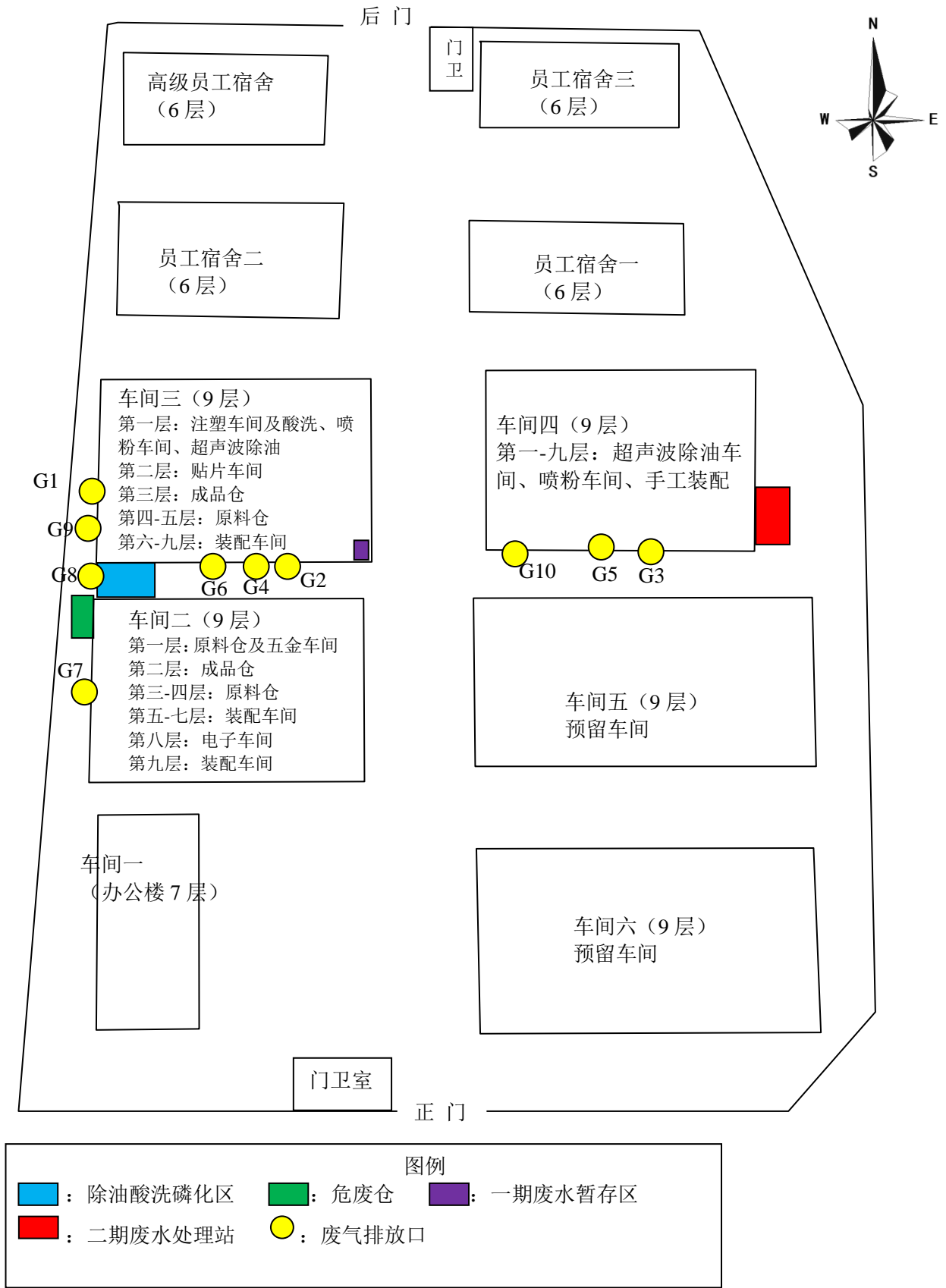
附图 3-1 项目总平面图
